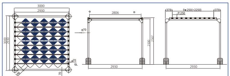
サイズ：W3000×D3000×H2500 主な仕様：手動組立式 主構造材：アルミ押出材フレーム / ポリエステルキャンバス
