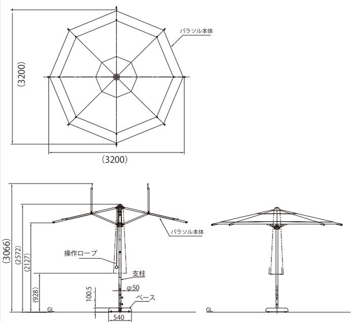
サイズ： $\phi 3200$ (8角) $\times$ H2572 構造材：フレーム\_アルミ押出材 キャンバス\_アクリル仕様,撥水加工
