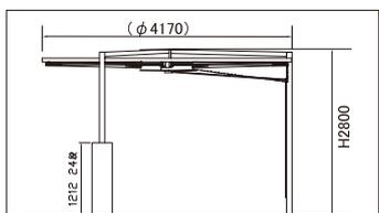
サイズ：φ4100×H2800 構造材：フレーム\_アルミ押出材 キャンバス\_アクリル仕様、撥水加工
