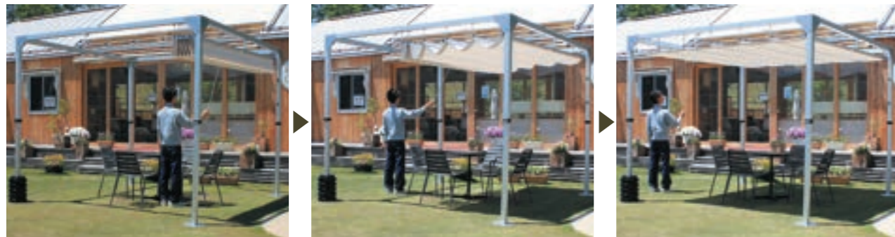
①キャンバスをフック棒で引く ②開き側一杯まで引く ③ロック金具へ掛け、完了
