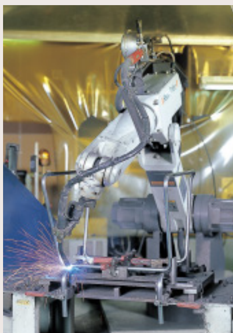
固定椅子ロボット溶接
